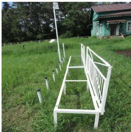
Рисунок 1.1 - Вытяжные почвенно-глубинные термометры ОГМС Иркутск (фото Блинова А.В.)
