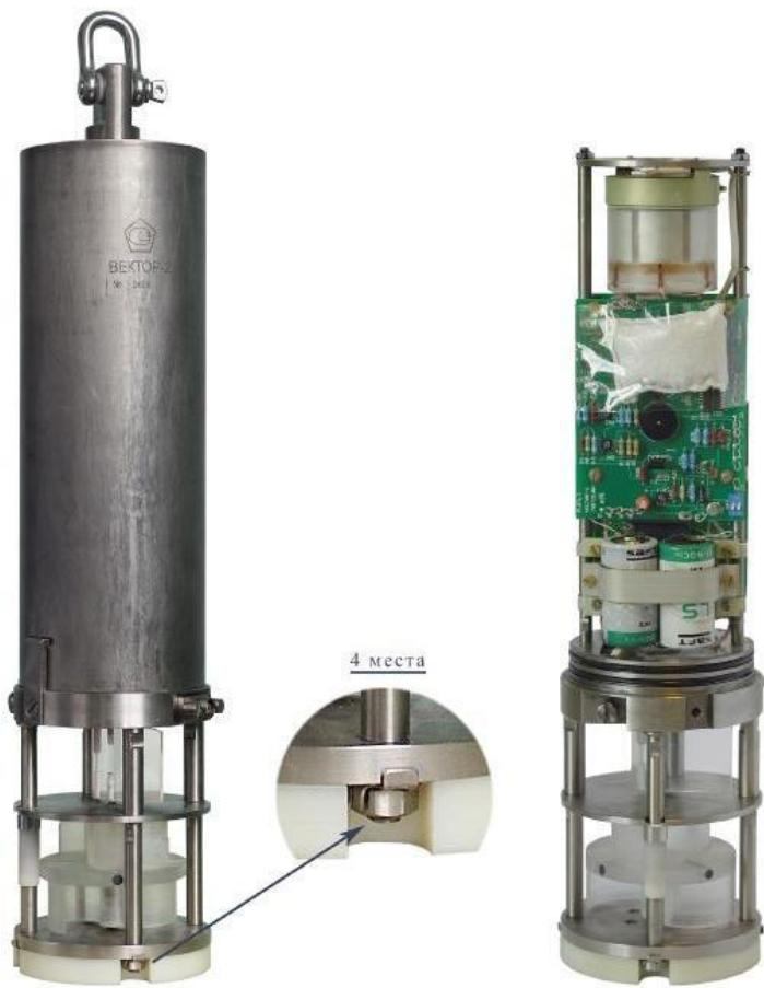
Рис. 1 Измерители скорости и направления течений Вектор-2
